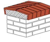
Mauerwerks-Abdeckung mit durchgehender Mittelfuge.
