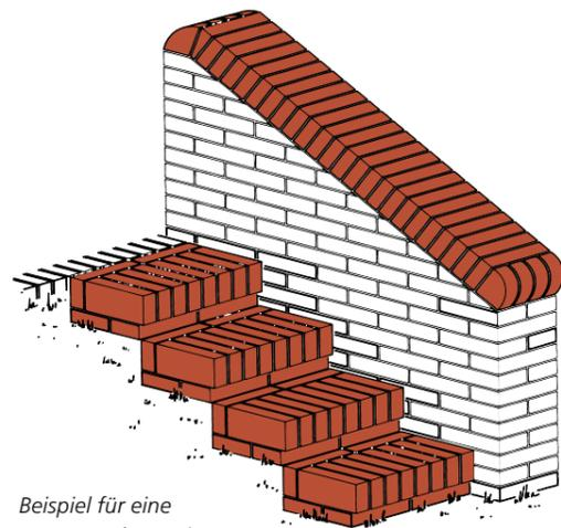
Beispiel für eine Treppenanlage mit Fertigstufen. Begrenzungsmauer mit vorgefertigter Abdeckung einschließlich Formsteinen
